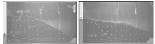
图 42 离心模型试验验证填埋体失稳警戒水位
